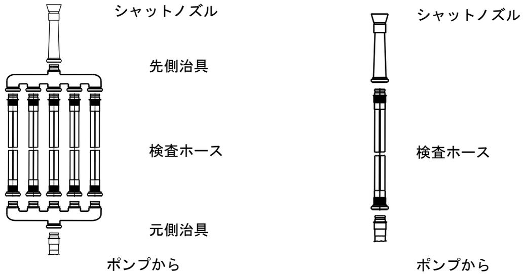
全長耐圧試験治具 分解図 (5本同時加圧用)
