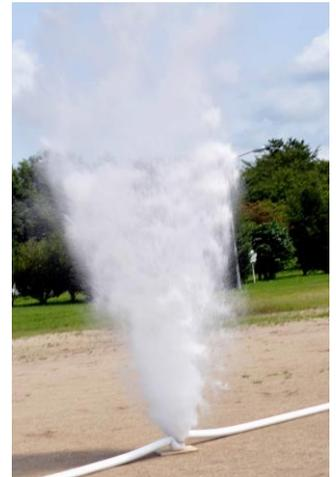
耐圧試験中に破断した場合
